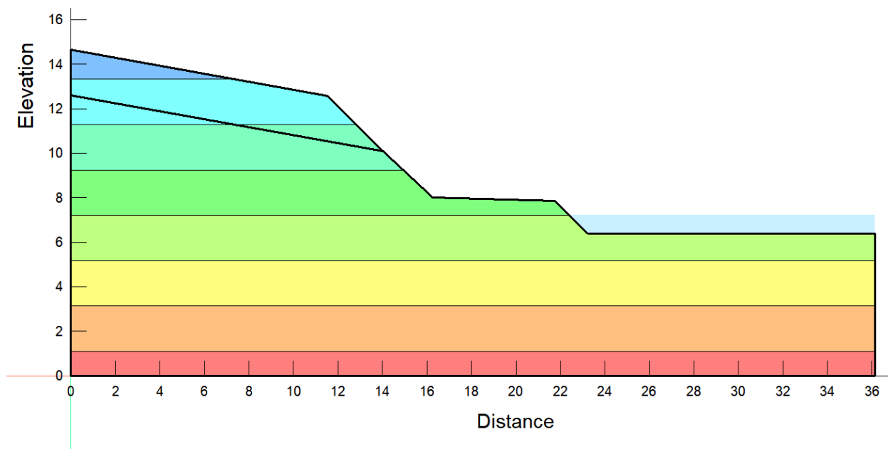
Figura 43 – andamento delle pressioni interstiziali della sezione tipo 1
